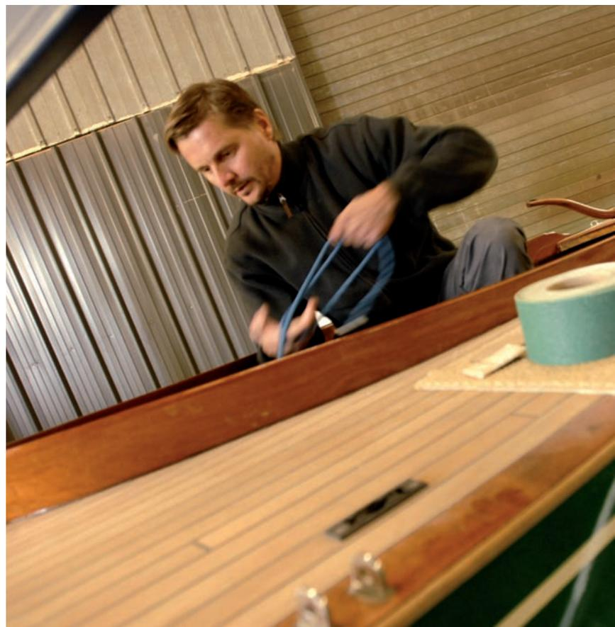
planking"), le tout enfermé dans une enveloppe époxy<sup>(1)</sup> à l'intérieur et à l'extérieur. Résultat : un bateau de 450 kg, "plus rigide et plus léger qu'un navire en polyester" et de surcroît facile d'entretien. L'avantage du "strip planking" étant aussi de pouvoir faire des bateaux sans moule, sur mesure.
