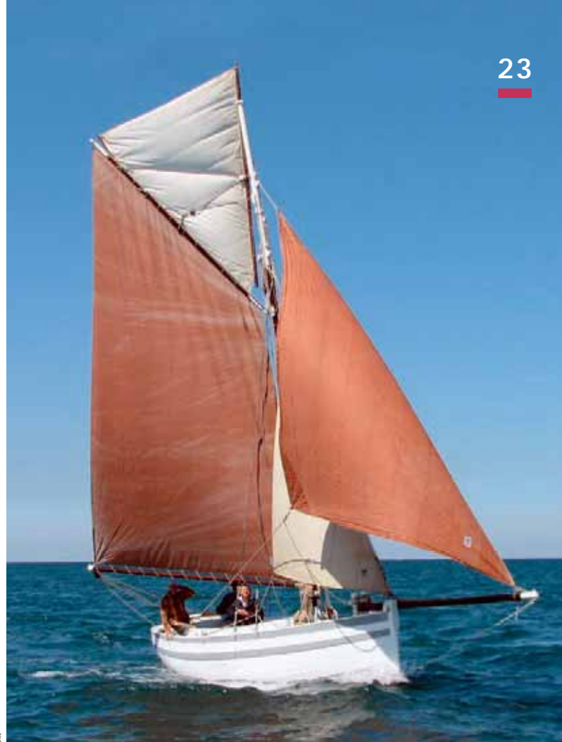
L'une des particularités du Rigel est sa grande surface de voilure par rapport à sa taille, ce qui en fait un bateau assez rapide.
